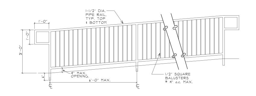
4 TYPICAL RAMP RAILING DETAIL
